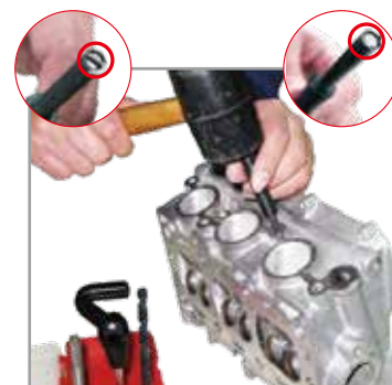
折取り工具を挿入し、ハンマーで叩き、タングを折り取ります。折取り工具にはマグネットが着いているためタングを探す手間が省けます。
