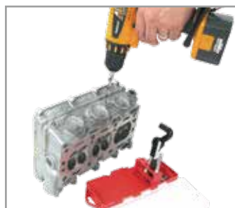
下穴用のドリルで穴を開けます。
